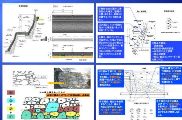
図9-2 石積み護岸の施工要領図 事例
