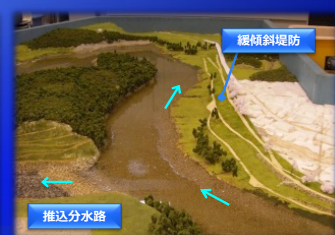
写真7-2 九州大学に作成した景観水理模型(縮尺S=1:200)
